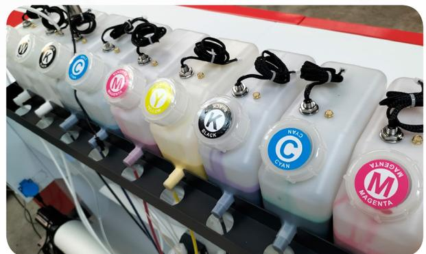
Equipado con botellas grandes de suministro de tinta de 1,5 litros, que aseguran el suministro ininterrumpido de tinta al cabezal.
